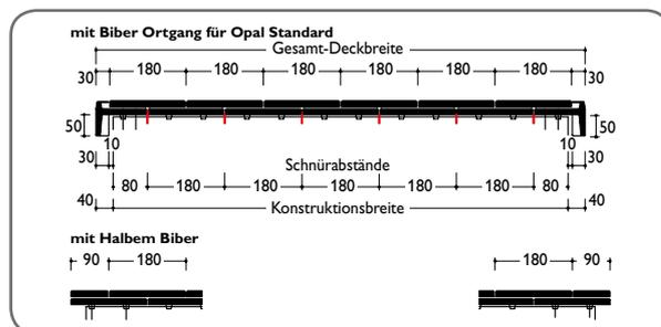
Die Biberschwanzziegel werden nach den Fachregeln des deutschen Dachdeckerhandwerks mit geringem Seitenabstand (Fugen) verlegt, um Schäden durch Bewegung der Unterkonstruktion zu vermeiden.
